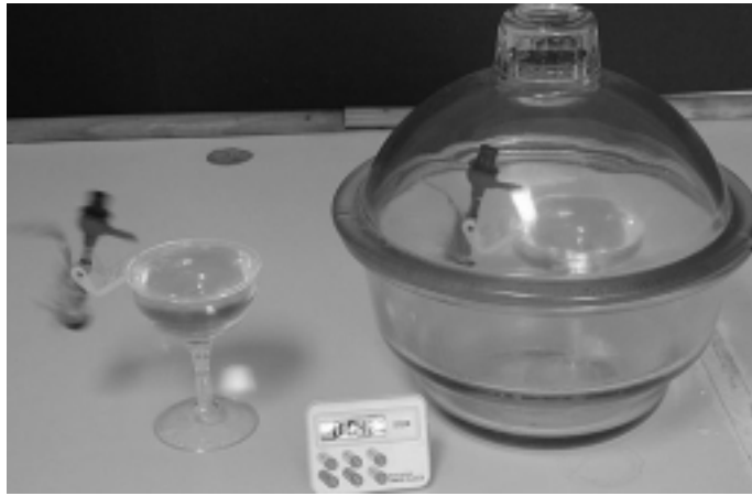
Figura 3: El pájaro bebedor colocado dentro de un desecador –recipiente de vidrio herméticamente cerrado– deja de oscilar al cabo de pocos minutos. Cuando la tapa del desecador vuelve a retirarse, el pájaro vuelve a oscilar en pocos segundos.
