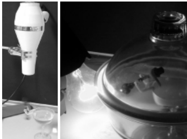
Figura 4: El pájaro bebedor colocado debajo de un ventilador de aire. Con una frecuencia de un trago cada 7 segundos se pasa a una frecuencia de 1 trago por segundo. Pájaro bebedor –con el bulbo inferior pintado de negro– sin agua iluminado por la luz de una bombilla próxima. El pájaro oscila normalmente.
